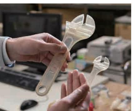
▲▼インクジェット式積層造形装置で作製
